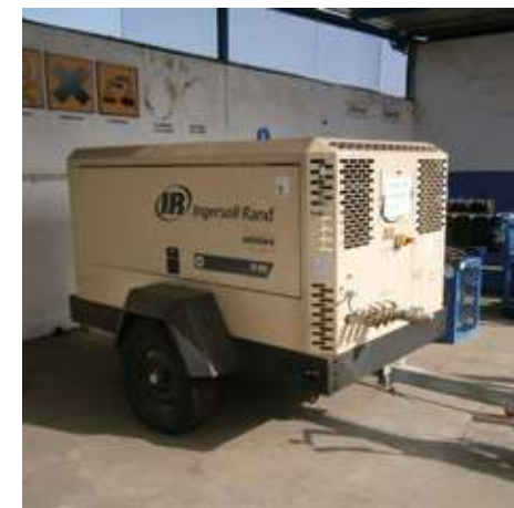
Exemple de compresseur thermique (diesel) Chantier
