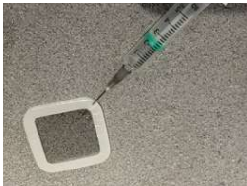
Test de Bresle (test de contamination saline)
