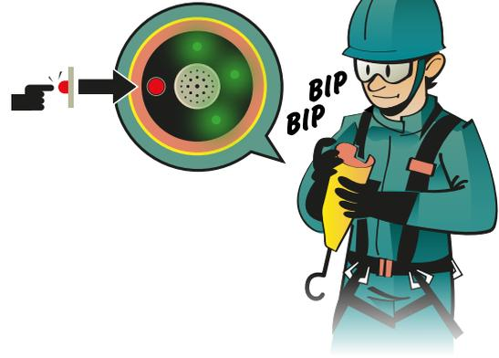
**7** Après la vérification d'absence de tension, je m'assure que le matériel utilisé et le VAT sont en bon état de fonctionnement
